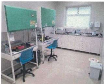
Sala de pré-PCR. Cabine para extração de ácidos nucleicos (esq.), cabine para preparo das reações (dir.)
